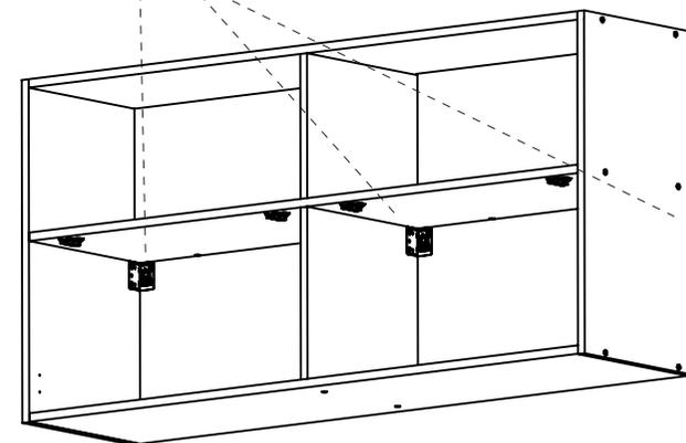
При установке нескольких модулей, рекомендуется скрепить их между собой стяжными винтами
