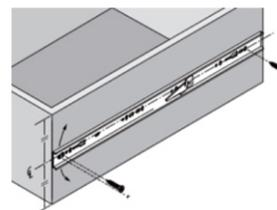
6. Установите направляющие (деталь №72), закрутите шурупы (деталь №54) в трех местах отверстий. Прodelайте аналогичные действия с двух сторон ящика.
